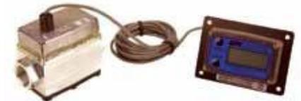
El armado del kit remoto aprobado por Factory Mutual (FM) modifica los medidores digitales electrónicos de GPI para aplicaciones en situaciones especializadas incluso indicación remota y aplicaciones de medición de alta o baja temperatura de fluidos. Este kit ofrece la versatilidad de montaje de panel de lectura LCD hasta 100 pies desde la turbina.
