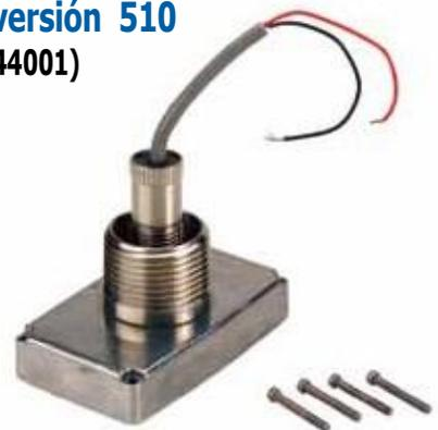
Utilizado con kit remoto, esta pieza sustituye la cubierta de suciedad que almacena el visor electrónico. Este módulo ofrece una señal de salida (NPN) digital, de colector abierto. Usar esta combinación para comunicar a un PLC u otra pieza de equipamiento electrónico.
