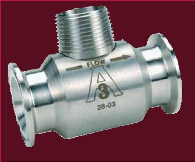
La línea de medidores de alta precisión es la más exacta de los medidores de flujo tipo turbina de GPI e incluye un diseño tradicional. Estos medidores vienen en diferentes tamaños y opciones de conexión que incluyen conexiones bridas BSP, ISO, NPT y ANSI. El GSCPS de esta sección cuenta con certificación sanitaria 3A.
