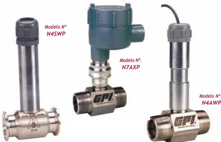
Las carcasas de captación son opcionales en la serie G Medidores. Elija de entre cuatro carcasas de captación. Los modelos N4A y N4S son carcasas impermeabilizables Para carcasas impermeabilizables a prueba de explosión, elija N7A para la carcasa sin regleta terminal o N7AT con regleta terminal.
